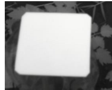
Chip de Teflón calibrador capturado por la cámara ADC Lite.
